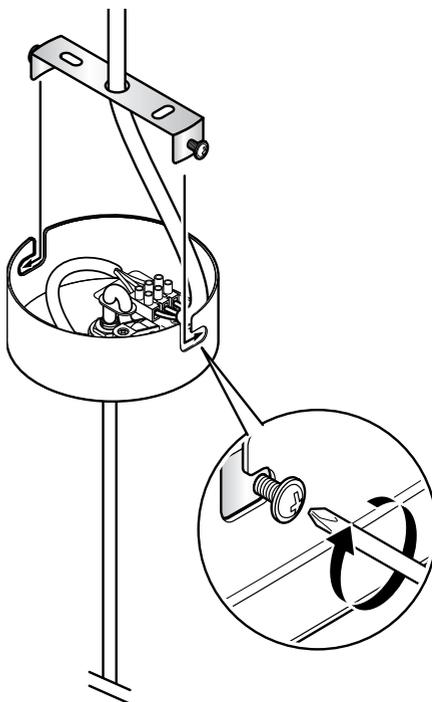
2. Schieben Sie den Leuchenträger auf die beiden leicht eingedrehten Befestigungsschrauben des Deckenbügels auf.
