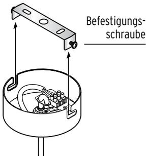
2. Lösen Sie die beiden seitlichen Befestigungsschrauben, mit denen der Deckenbügel am Leuchten-träger befestigt ist, so weit, dass Sie den Deckenbügel abnehmen können.
