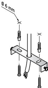
5. Befestigen Sie den Deckenbügel mit den Dübeln und Schrauben an der Decke.
