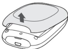
1. Öffnen Sie den Router durch kräftiges Auseinanderziehen der zwei Gehäuseschalen an der Einkerbung. Im Router sehen Sie die bereits fertig eingelegte SIM-Karte.
