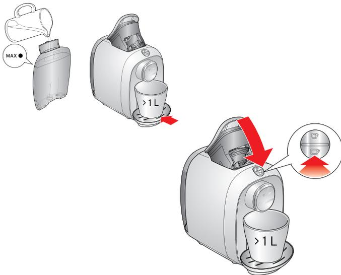
1. Füllen Sie den Wasserbehälter **bis zur MAX-Markierung** mit Entkalker, wie im vorhergehenden Absatz beschrieben. Wenn Sie zu wenig einfüllen, wird eine Fehlermeldung angezeigt (Tasten blinken abwechselnd).
