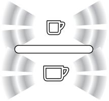
Beide Tasten blinken gleichmäßig = Maschine in den nächsten Tagen entkalken.
