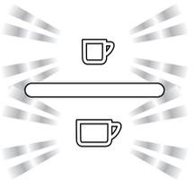
Beide Tasten blinken doppelt = Maschine stoppt aufgrund starker Verkalkung komplett. Sie ist erst nach dem Entkalken wieder einsatzbereit.
