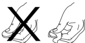
Durch Berührung der Batterie mit bloßen Händen können an den Kontakten Verunreinigungen entstehen, die isolierend wirken. Fassen Sie daher die Batterie mit einem trockenen, weichen Tuch an.
