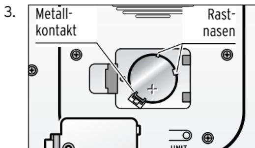
Schieben Sie die beiliegende Batterie unter die Rastnasen und drücken Sie sie ins Batteriefach, so dass sie unter dem Metallkontakt liegt.
