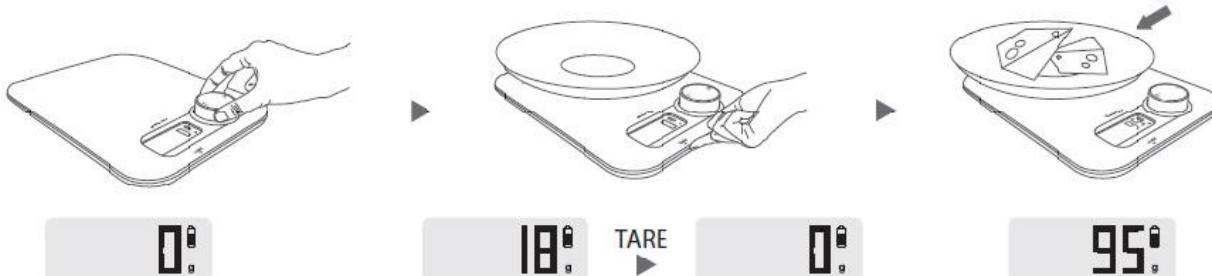
Posizionare un contenitore qualsiasi sul piatto di pesatura. Sul display LCD viene visualizzato il peso del contenitore.
