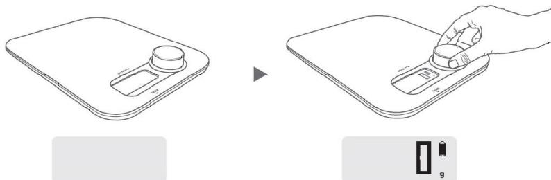
Drehen Sie den Knopf im Uhrzeigersinn bis 0 im Display erscheint und damit der Kondensator mittels Dynamo-Technologie voll geladen ist.
