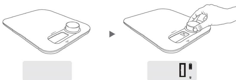
Tournez le bouton dans le sens des aiguilles d'une montre jusqu'à ce que "0" s'affiche à l'écran, afin que le condensateur soit complètement chargé à l'aide de la technologie de dynamo.
