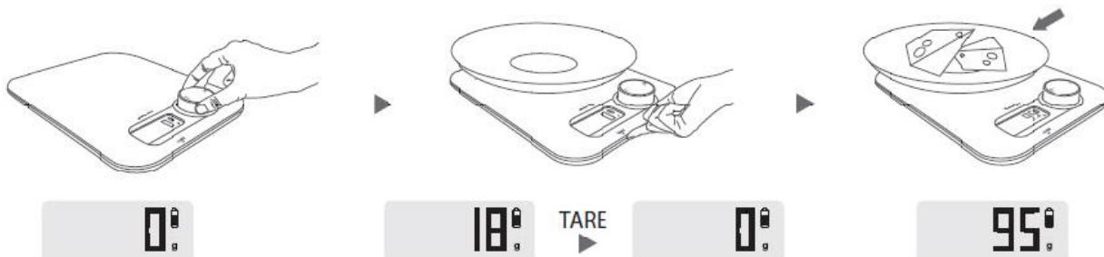
Colocar un recipiente en la bandeja de pesaje, la pantalla LCD muestra el peso del contenedor.
