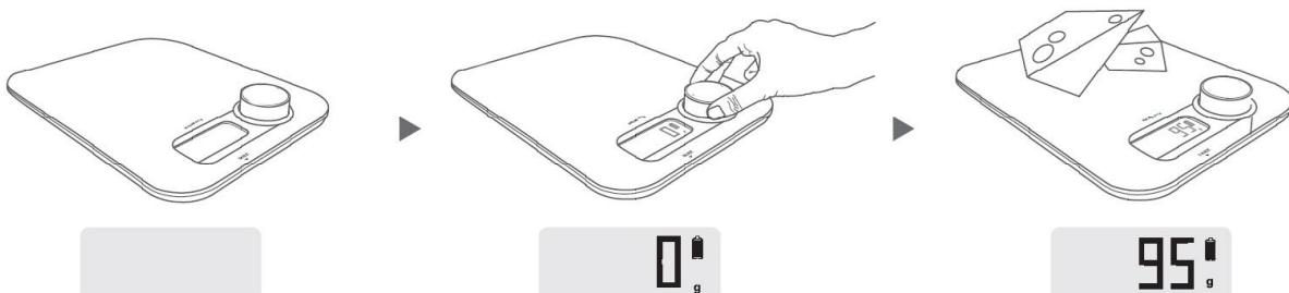
Поверните кнопку по часовой стрелке, пока на дисплее не появится 0. Положите на весы продукт для взвешивания, на дисплее будет показываться соответствующий вес.
