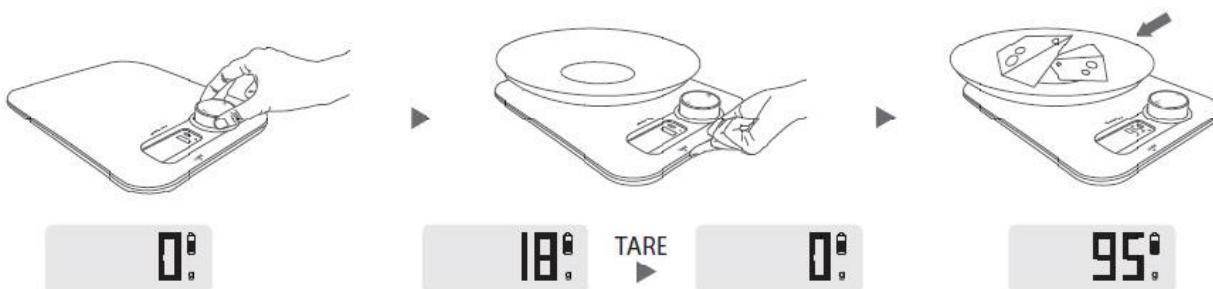
Plaats een container op het weegvlak, het LCD-scherm toont het gewicht van de container. Druk op de toest TARE, op het display op nul. Dus het gewicht van de container verwijderd en u kunt weegt de inhoud van de container.
