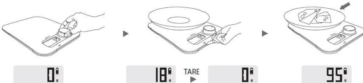
Stellen Sie einen Behälter auf die Wiegefläche, das LCD Display zeigt das Gewicht des Behälters an.
