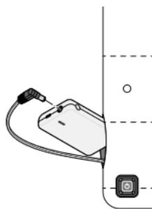
3. Schließen Sie das Anschlusskabel des Akku-Heizponchos an die Ausgangsbuchse des Akkus an.
