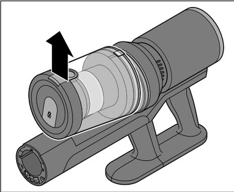
1. Drücken Sie die Entriegelung des Auffangbehälters und nehmen Sie den Auffangbehälter ab.
