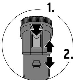
Die Bürste an der ausziehbaren Fugendüse kann je nach Bedarf vor- oder zurückgeschoben werden.
