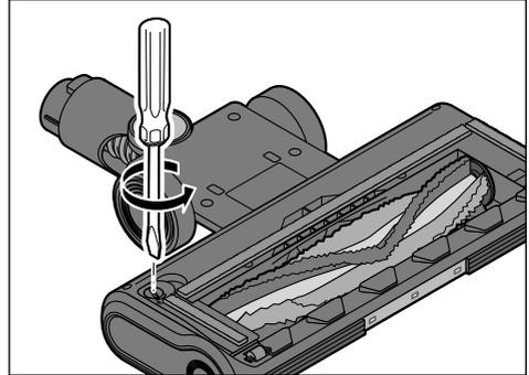
2. Lösen Sie die Schraube auf der Unterseite der Bodendüse.
