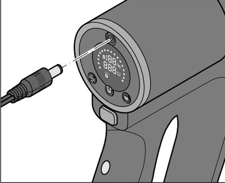
1. Schließen Sie den Netzadapter an den Motorblock an.
