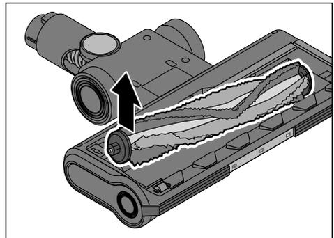
4. Heben Sie die Bürstenwalze an der einen Seite an und ziehen Sie sie aus der Halterung heraus.
