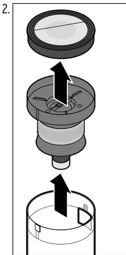
Drücken Sie den Filtereinsatz wie abgebildet in Pfeilrichtung aus dem Auffangbehälter heraus.
