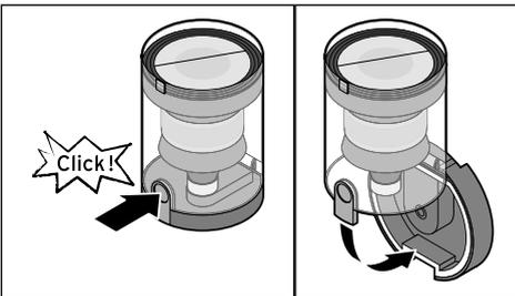
2. Halten Sie den Auffangbehälter über einen Mülleimer und drücken die Entriegelung des Auffangbehälter-Deckels. Der Deckel öffnet sich und der aufgesaugte Staub fällt heraus.
