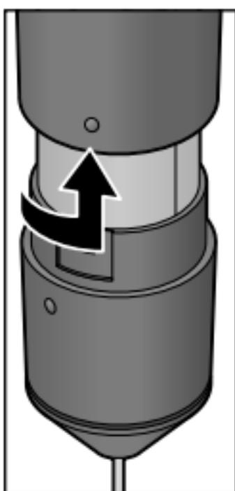
Entfernen Sie die Batterie-fachkappe wie abgebildet vom Gerät.
