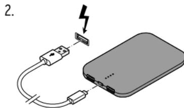
Schließen Sie den kleinen Stecker des beiliegenden Ladekabels an die Eingangsbuchse am Akku an.
