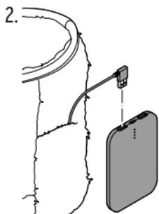
2. Schließen Sie jeweils das Anschlusskabel des Heizschuhs an eine der Ausgangsbuchsen des Akkus an.
