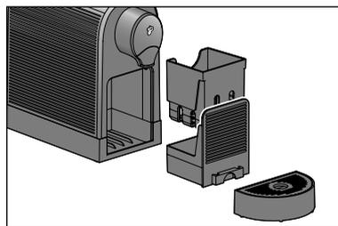
3. Entnehmen Sie den Kapsel-Auffangbehälter. Der Kapsel-Auffangbehälter muss täglich geleert werden bzw. wenn er voll ist. In den Auffangbehälter passen ca. 6 Kapseln hinein.
