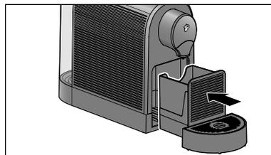
2. Vergewissern Sie sich, dass der Kapsel-Auffangbehälter korrekt in der Frontschublade sitzt. Die Frontschublade muss bis zum Anschlag eingeschoben und die Abtropfschale korrekt eingesetzt sein.
