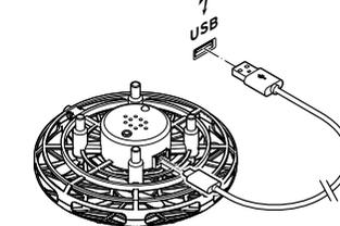
Schalten Sie das Gerät aus und schließen Sie es an einen passenden USB-Port an. Während des Ladens leuchtet die rote LED. Sobald der Akku vollständig aufgeladen ist, erlischt die LED.
