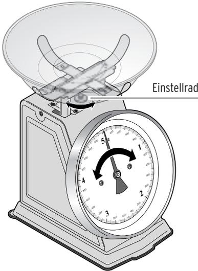
Um den Zeiger der Waage vor dem Wiegen auf Null einzustellen, drehen Sie das Einstellrad, bis der Zeiger in der Anzeige auf 5 kg steht (**5 kg = 0 kg**).
