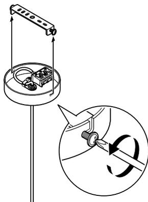
3. Lösen Sie die beiden seitlichen Befestigungsschrauben, mit denen der Deckenbügel am Leuchtenträger befestigt ist, so weit, dass Sie den Deckenbügel abnehmen können.
