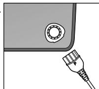
Ziehen Sie den Anschlussstecker der Bedieneinheit aus der Anschlussbuchse am Heizkissen.
