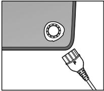
▷ Wenn das Heizkissen und die Anschlussbuchse komplett getrocknet sind, stecken Sie den Anschlussstecker wieder in die Anschlussbuchse. Der Stecker passt nur in einer Position in die Buchse. Die Seite mit **P** muss wie abgebildet oben sein.
