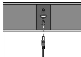
1. Schließen Sie den Netzadapter an die Netzadapterbuchse **DC9V** hinten am Gerät an.
