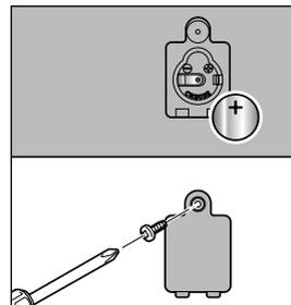
1. Drehen Sie die Schraube heraus und nehmen Sie den Batteriefachdeckel ab.
