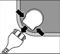
Ziehen Sie den Anschlussstecker der Bedieneinheit aus der Anschlussbuchse am Heizkissen. Drücken Sie dazu auf die beiden seitlichen Tasten an der Anschlussbuchse, um die beiden Haken des Anschlusssteckers aus der Verastung zu lösen.
