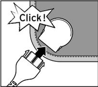
Stecken Sie den Anschlussstecker der Bedieneinheit wie abgebildet in die Anschlussbuchse am Heizkissen. Die beiden seitlichen Haken müssen in der Anschlussbuchse einrasten.
