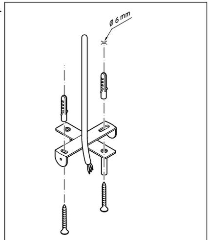
Befestigen Sie den Deckenbügel mit den Dübeln und Schrauben an der Decke.
