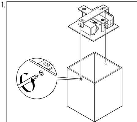
Drehen Sie die beiden seitlichen Befestigungsschrauben am Lampenschirm heraus, um den Deckenbügel samt Trägerplatte abzunehmen.
