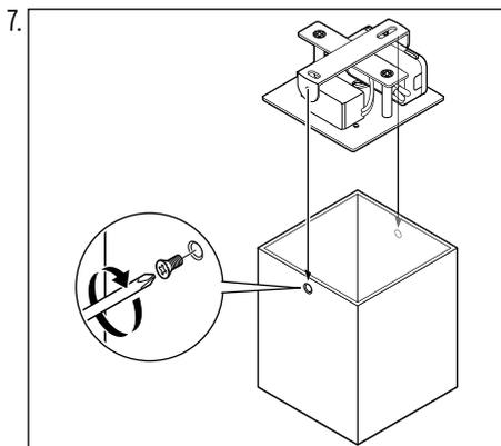
Platzieren Sie den Anschlusskasten zwischen Deckelbügel und Trägerplatte. Befestigen Sie anschließend den Lampenschirm wieder am Deckenbügel.
