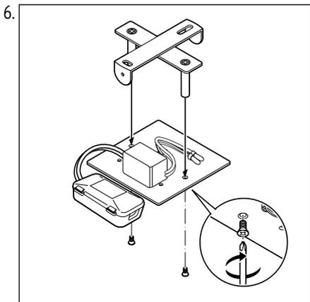
Befestigen Sie die Trägerplatte wieder am Deckenbügel.
