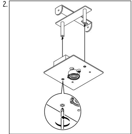
Drehen Sie die beiden Befestigungsschrauben auf der **Unterseite der Trägerplatte** heraus, um den Deckenbügel von der Trägerplatte abzunehmen.
