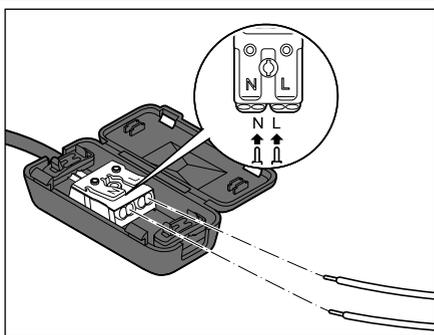
Lassen Sie die Stromleitungen von einer Fachkraft mit der Lüsterklemme im Anschlusskasten verbinden.
