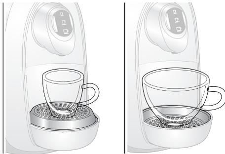
Für kleine Tassen drehen Sie einfach das Abtropfgitter um. Durch den geringeren Abstand zum Getränke-Auslauf werden übermäßige Spritzer vermieden.
