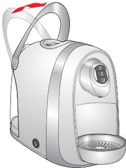
Klappen Sie den Hebel nach jedem Brühvorgang immer zurück, damit die Kapsel herausfällt und der Druck im System entweichen kann. Dabei kann noch Restflüssigkeit austreten.
