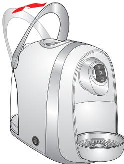
7. Klappen Sie den Hebel zurück, damit der Druck aus dem System entweichen kann. Dabei tropft noch etwas Wasser nach.
