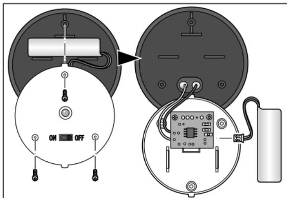
3. Das Elektronikgehäuse ist über Kabel mit der Akkufach-Abdeckung verbunden. Nehmen Sie die Abdeckung daher vorsichtig ab, ohne die Kabel loszureißen.
