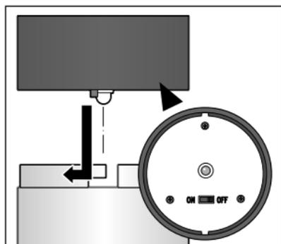
1. Drehen Sie das Solarmodul gegen den Uhrzeigersinn und nehmen Sie es nach oben ab.
