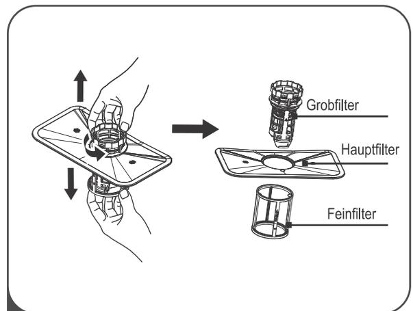
**2** Der Feinfilter kann vom Boden der Filtereinheit abgezogen werden. Der Grobfilter lässt sich vom Hauptfilter lösen, indem man die Laschen oben leicht zusammendrückt und wegzieht.
