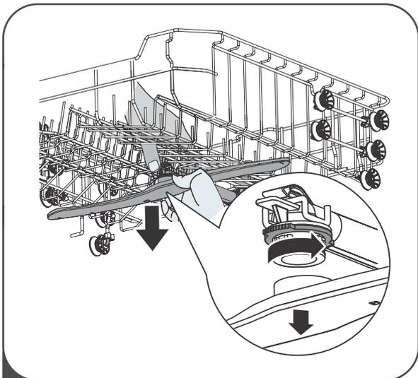
**1** Um den Oberen Sprüharm (wo vorhanden) zu entfernen, halten Sie die Mutter in der Mitte fest und drehen Sie den Sprüharm gegen den Uhrzeigersinn, um ihn zu entfernen.
