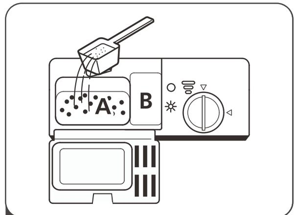
2 Geben Sie Spülmittel in die größere Mulde (A) für den Hauptwaschgang . Geben Sie bei stärker verschmutzten Waschladungen auch etwas Spülmittel in die kleinere Mulde (B) für den Vorspülgang .
