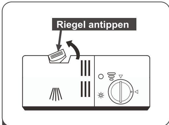
1 Drücken Sie die Entriegelung am Spülmittelbehälter, um die Abdeckung zu öffnen.
