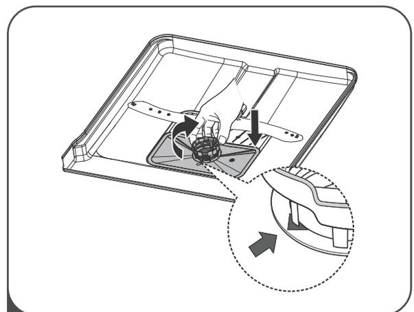
**4** Setzen Sie die Filter in umgekehrter Reihenfolge wieder zusammen, setzen Sie den Filtereinsatz wieder ein und drehen Sie ihn im Uhrzeigersinn bis zum Schließpfeil.
