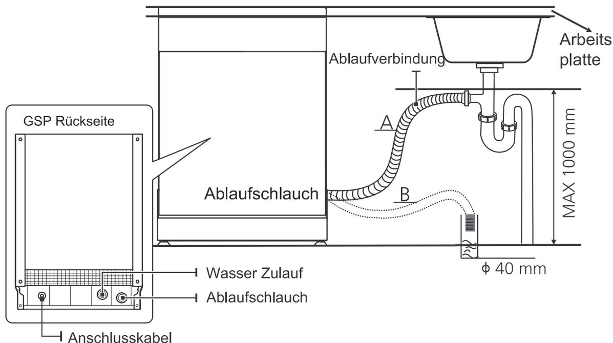
**So lassen Sie überschüssiges Wasser aus Schläuchen ab:** Wenn der Anschluss zum Abflussrohr höher als 1000 mm positioniert ist, kann überschüssiges Wasser im Ablaufschlauch verbleiben. Überschüssiges Wasser aus dem Schlauch muss in eine Schüssel oder einen geeigneten Behälter abgelassen werden, der außerhalb und unterhalb des Waschbeckens steht.
