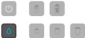
Wenn die Taste **Pflege** nach dem Einschalten ca. 3 Sekunden **blau** leuchtet, muss die Maschine gereinigt werden. **Der Reinigungsvorgang dauert ca. 5 Minuten.**
