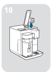
▶ Lege eine Qbo-Kaffeekapsel in die Maschine ein. Das "Q" auf der Kapsel muss nach vorne zeigen.
