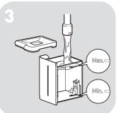
▶ Fülle den Wassertank mit frischem, klarem Leitungswasser bis zur Max.-Markierung.
