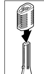
1. Schieben Sie den Aufsteckkamm so auf den Schneidkopf, dass sich die Zinken mit der gewünschten Schnittlänge - 6 oder 3 mm - auf der Schneideseite befinden, die Sie verwenden wollen. Achten Sie beim Aufschieben auf die Führungen im Aufsteckkamm und außen am Schneidkopf.
