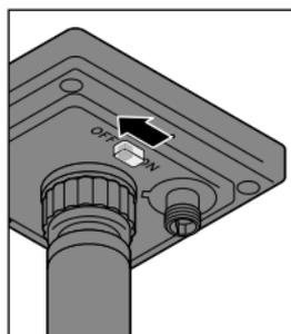
▷ Um die Lichterkette ggf. zu deaktivieren, schieben Sie den Ein-/Aus-Schalter auf der Unterseite des Solarmoduls auf **OFF**.
