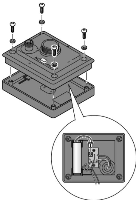
3. Lösen Sie die Schrauben auf der Unterseite des Solarmoduls mit einem Kreuzschlitzschraubendreher und nehmen Sie die Abdeckung ab.
