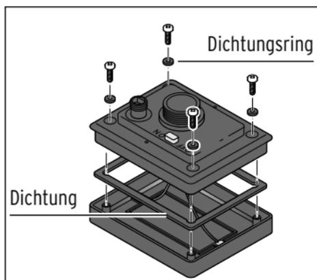
5. Setzen Sie die Abdeckung wieder auf das Solarmodul und drehen Sie die Schrauben fest. Achten Sie auf den korrekten Sitz der Dichtung des Solarmoduls und der Dichtungsringe der Schrauben.
