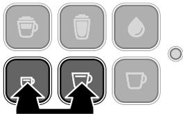
1. Schalten Sie die Maschine aus: Drücken Sie hierfür gleichzeitig die Taste **Espresso** und die Taste **Caffè Crema**.
