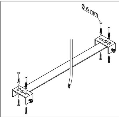
Befestigen Sie den Deckenbügel mit den Dübeln und Schrauben an der Decke.
