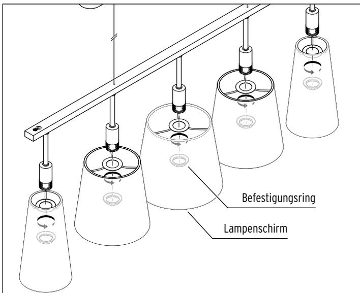
3. Drehen Sie die Befestigungsringe von den Fassungen ab, schieben Sie das Gestell der Lampenschirme über die Fassungen und drehen Sie die Befestigungsringe wieder auf.
