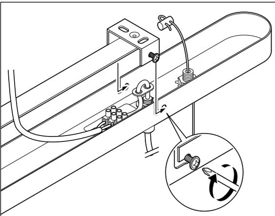
1. Schieben Sie den Leuchenträger auf die vier leicht eingedrehten Befestigungsschrauben des Deckenbügels auf.
