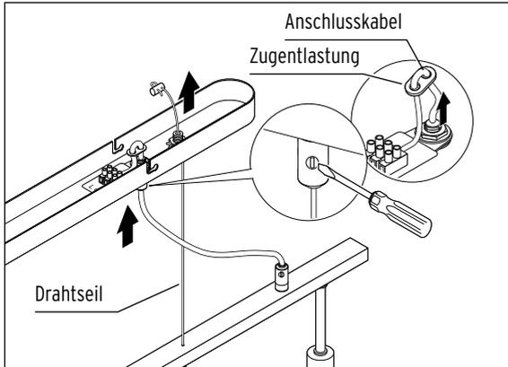
1. Schieben Sie die Drahtseile und ggf. das Anschlusskabel so weit in den Leuchenträger hinein, dass die Pendelleuchte in der gewünschten Höhe hängt.
