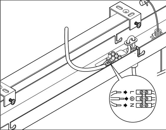
Lassen Sie die Stromleitung von einer Fachkraft mit der Lüsterklemme verbinden.
