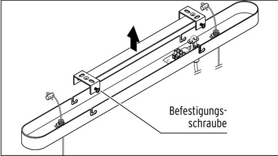
Lösen Sie die vier seitlichen Befestigungsschrauben, mit denen der Deckenbügel am Leuchenträger befestigt ist, so weit, dass Sie den Deckenbügel abnehmen können.
