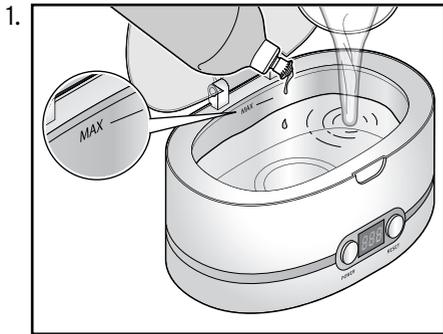
Füllen Sie Wasser in das Gerät und geben Sie zwei bis drei Spritzer mildes Spülmittel bzw. spezielle Ultraschallreinigungslösung hinzu.
