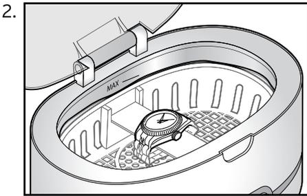
Legen Sie die Uhr wie abgebildet über den Uhrenhalter. **Das Uhrengehäuse muss über dem Wasser liegen.**
