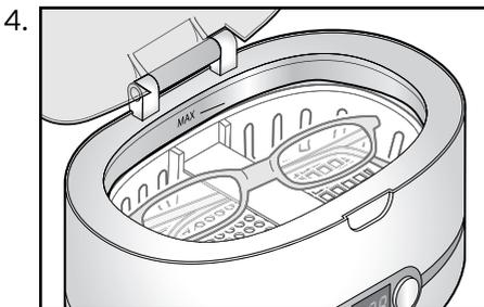
Setzen Sie vorsichtig den befüllten Siebeinsatz in das Gerät.
