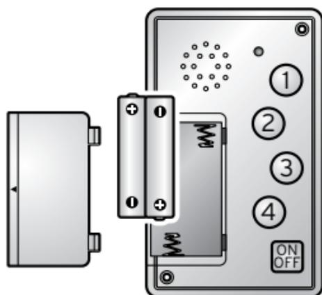
Ein Wechseln der Batterien wird erforderlich, sobald die Kontrollleuchte jede Sekunde blinkt.
