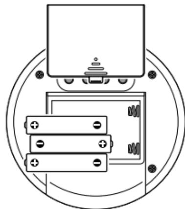
1. Poussez le couvercle du compartiment à piles dans le sens de la flèche et retirez-le de l'appareil.
