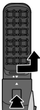
1. Halten Sie die Entriegelungstaste am Griff gedrückt und drehen Sie den bereits aufgesetzten Aufsatz in Pfeilrichtung, sodass die Punktmarkierung am Aufsatz über der Dreieck-Markierung am Griff liegt.
