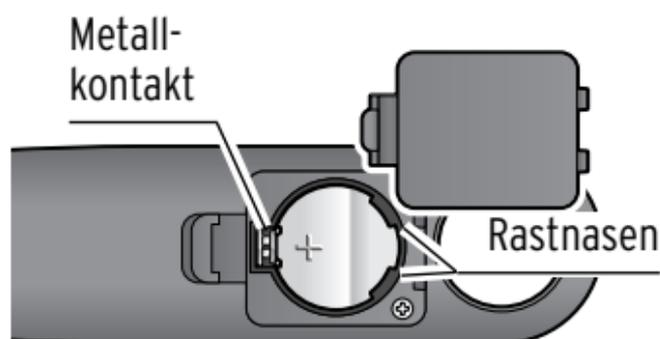
2. Schieben Sie die mitgelieferte Batterie unter die Rastnasen und drücken Sie sie ins Batteriefach, sodass sie unter dem Metallkontakt liegt. Achten Sie dabei auf die richtige Polarität. Der Pluspol (+) muss nach oben zeigen.
