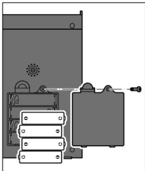
1. Lösen Sie die Schraube am Batteriefach und nehmen Sie den Batteriefachdeckel ab.
