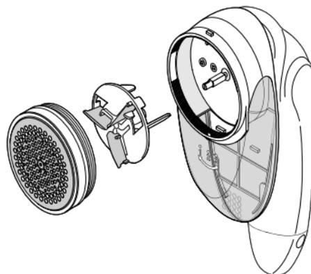
3. Schrauben Sie die Scherfläche gegen den Uhrzeigersinn ab.
