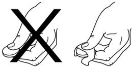
Durch Berührung der Batterie mit bloßen Händen können an den Kontakten Verunreinigungen entstehen, die isolierend wirken.
