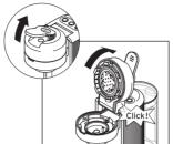
Klapp zuerst den Verriegelungshebel und dann den kompletten oberen Brühkopf hoch, bis dieser hör- und spürbar einrastet.
