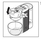
10. Klapp den oberen Brühkopf und anschlieβend den Verriegelungshebel herunter. Beide müssen hör- und spürbar einrasten. Achtung: Wenn nach Einschalten der Maschine die 3 Bedientasten blinken und bei Tastendruck 2 Signaltöne ertönen, ist der Brühkopf oder der Verriegelungshebel nicht korrekt geschlossen.
