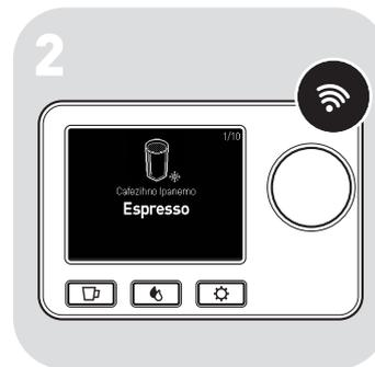
▷ Warte einen kurzen Moment, bis die WLAN-Kontroll-Leuchte dauerhaft leuchtet.
