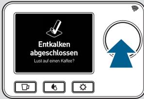
Sobald im Display „Entkalken abgeschlossen“ angezeigt wird, ist der Entkalkungsvorgang abgeschlossen.
