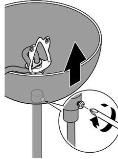
Schieben Sie den Baldachin nach oben über die Anschlüsse und drehen Sie die Befestigungsschraube wieder fest.
