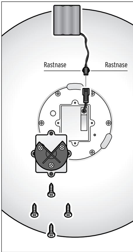
1. Lösen Sie die vier Schrauben der Akkufach-Abdeckung mit einem Kreuzschlitzschraubendreher.
