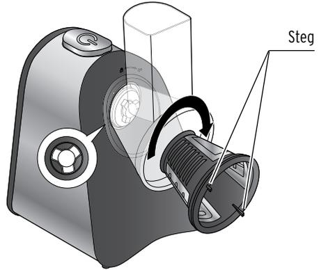
3. Setzen Sie den gewünschten Trommeleinsatz wie abgebildet auf die Antriebsachse und drehen Sie ihn dann zum Verriegeln im Uhrzeigersinn. Fassen Sie den Trommeleinsatz dabei an den beiden kleinen Stegen an.
