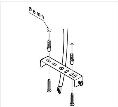
Befestigen Sie den Deckenbügel mit den Dübeln und Schrauben an der Decke.
