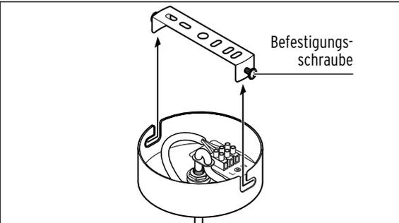
Lösen Sie die beiden seitlichen Befestigungsschrauben, mit denen der Deckenbügel am Leuchenträger befestigt ist, so weit, dass Sie den Deckenbügel abnehmen können.
