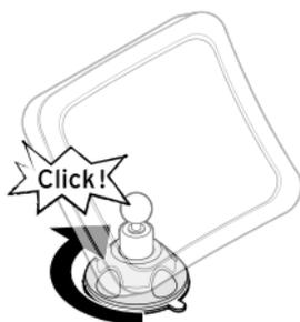
Drehen Sie den Saugnapffuß im Uhrzeigersinn, bis er hör- und spürbar einrastet.
