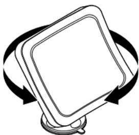
Der LED-Kosmetikspiegel ist über ein Kugelgelenk am Saugnapffuß befestigt und lässt sich dadurch in nahezu alle Richtungen schwenken und drehen.
