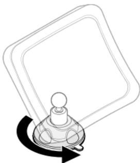
Drehen Sie den Saugnapffuß gegen den Uhrzeigersinn, bis er sich spürbar löst.
