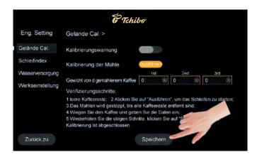
**Schritt 1:** Leeren Sie den Mahlgutbehälter, legen Sie ihn auf die Waage, wiegen Sie ihn und legen Sie ihn dann wieder in die Maschine.
