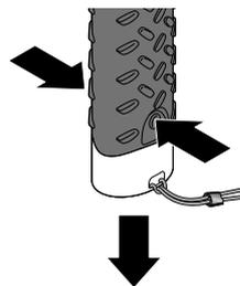
1. Appuyez des deux côtés sur les surfaces d'appui et retirez le couvercle du compartiment à piles de l'appareil.
