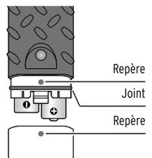
2. Mettez les piles comprises dans la livraison en place dans le compartiment à piles comme représenté sur l'illustration. Respectez la bonne polarité (+/-). Vérifiez que le joint est propre et n'est pas endommagé et qu'il se trouve dans la position correcte.
