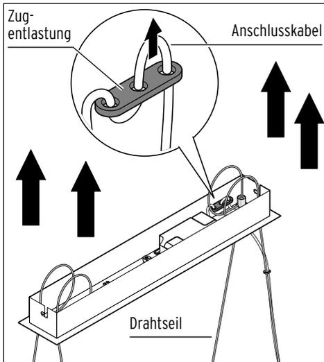
1. Schieben Sie die Drahtseile und das Anschlusskabel so weit in den Leuchenträger hinein, dass das Dekotablett mit der LED-Lichtleiste in der gewünschten Höhe hängt.
