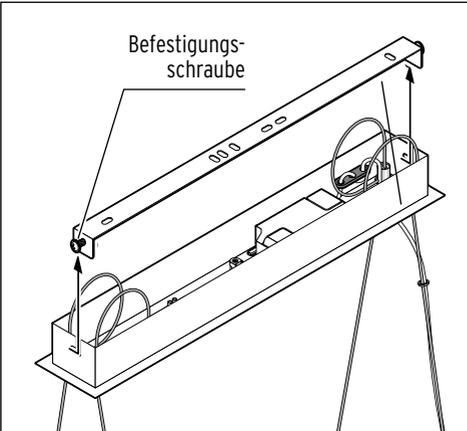
Lösen Sie die beiden seitlichen Befestigungsschrauben, mit denen der Deckenbügel am Leuchtenträger befestigt ist, so weit, dass Sie den Deckenbügel abnehmen können.
