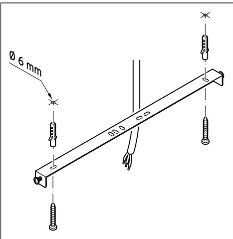
Befestigen Sie den Deckenbügel mit den Dübeln und Schrauben an der Decke.
