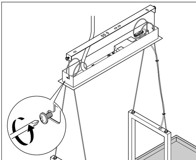
1. Schieben Sie den Leuchenträger auf die beiden seitlichen Befestigungsschrauben des Deckenbügels auf.
