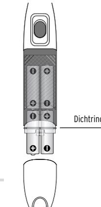
2. Setzen Sie die mitgelieferten Batterien wie im Batteriefach abgebildet ein. Achten Sie dabei auf die korrekte Polarität (+/-). Kontrollieren Sie, ob der Dichtring sauber und unbeschädigt ist und sich in der richtigen Position befindet.
