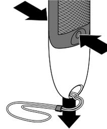
1. Drücken Sie auf beiden Seiten auf die Druckflächen und ziehen Sie den Batteriefachdeckel vom Gerät ab.
