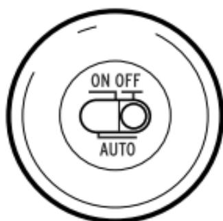
**ON** = LEDs dauerhaft eingeschaltet
