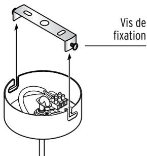
2. Dévissez les deux vis latérales fixant l'étrier de la suspension au cache-fils jusqu'à ce que vous puissiez retirer l'étrier.
