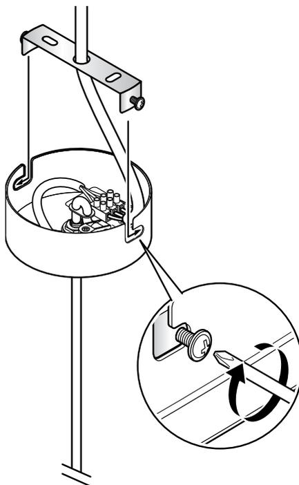
2. Engagez le cache-fils sur les deux vis de serrage de l'étrier de fixation, légèrement vissées.
